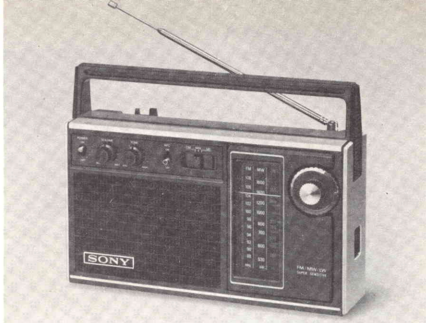
Fig. 3 - Radioportatile FM, OL, OM Sony mod. TFM-7210L, alimentata a 6 Vcc.
