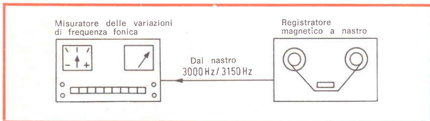
Fig. 3 - Controllo della velocità del nastro con misuratore delle variazioni di frequenza fonica.
