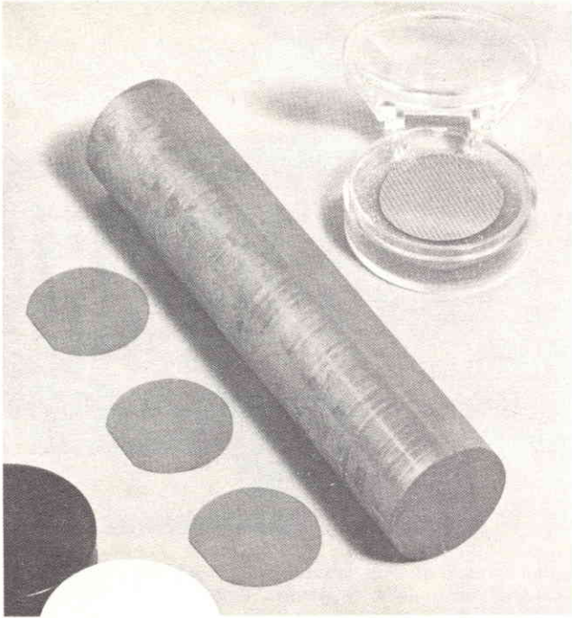
Fig. 103 - Barra di silicio monocristallino. Si vedono alcune «fettine» (slices) di silicio, mentre dentro al contenitore in vetro si trova una piastrina di silicio nella quale sono stati già formati un gran numero di circuiti integrati uguali (chips).
