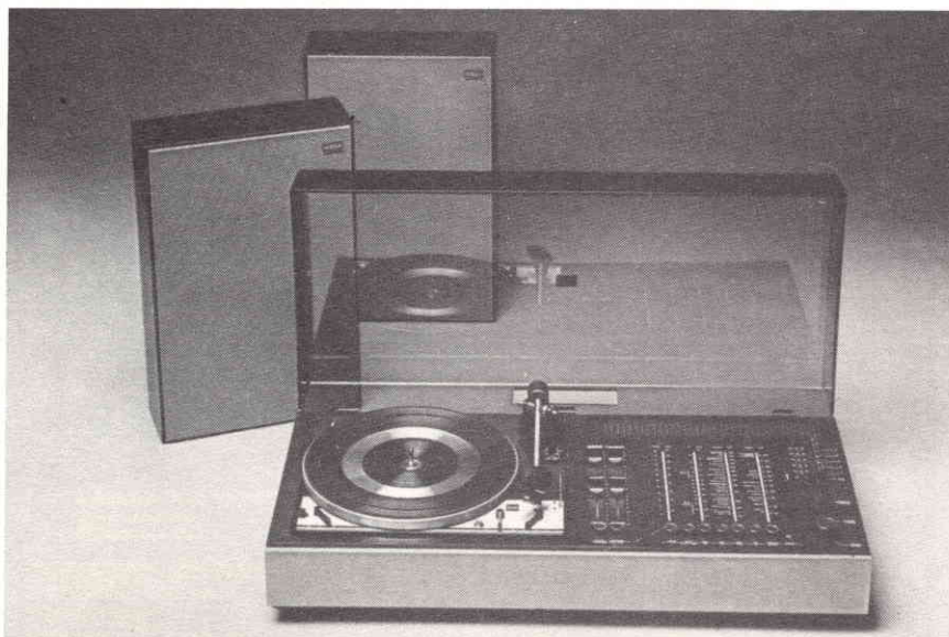
Fig. 19 - Combinazione WEGA HI-FI 3212B con sintonizzatore FM, OM, OL, OC, amplificatore stereo 2 x 18 W (2 x 25 musicali), giradischi Dual, due casse acustiche LB 3516.
