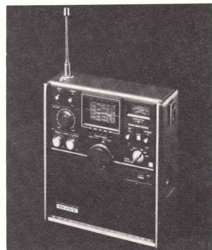
Fig. 5 - Ricevitore SONY ICF-5800L a 5 gamme FM, OL, OM, banda marina OC, alimentato in continua a 6 V.
