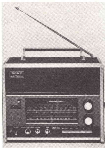
Fig. 10 - Ricevitore portatile a 13 gamme FM, OL, OM, OC ( 1,6 \div 26 MHz) modello CRF-5080, alimentato a 9 Vc.c. o 110 \div 140 Vc.a. Potenza di uscita 2,5 W.
