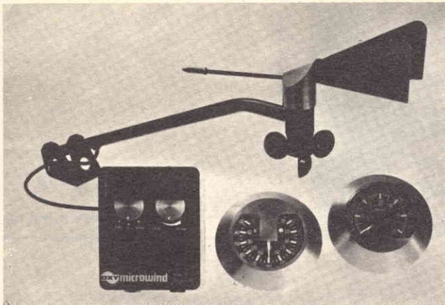
Fig. 2 - Il Microwind, un anemometro elettronico, alimentato a batterie di pile, della Oxy Nautica, per l'indicazione della direzione (anche amplificata) e della velocità del vento, per imbarcazioni da diporto.
