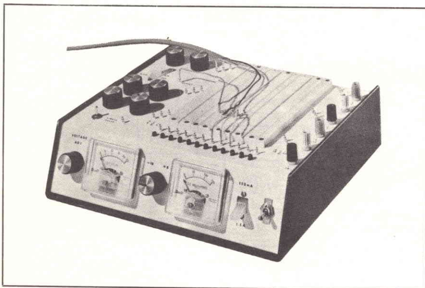
Fig. 19 - Fotografia dell'apparecchiatura, così come è stata realizzata dall'Autore, per semplificare le operazioni di collaudo di un determinato circuito.
